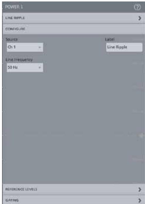
图 15. 5-PWR 的工频纹波配置标签。
