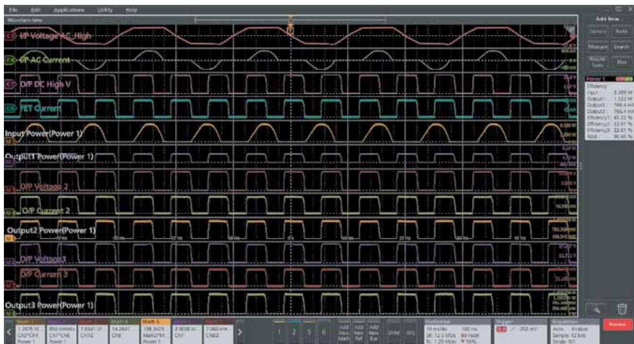
图 17. 使用 5-PWR 进行效率测量。
