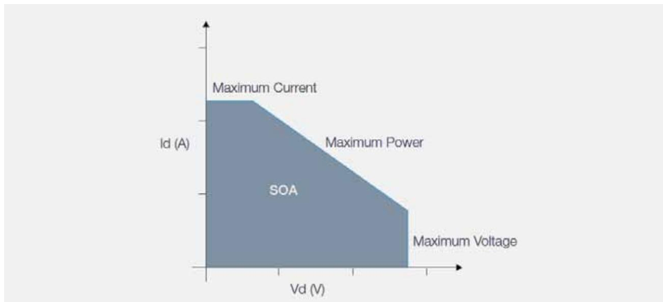
图 11. 晶体管的安全工作区 (SOA) 图。
