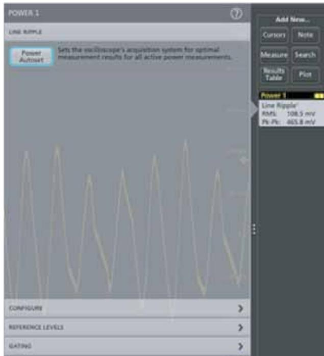
图 16. 使用 5-PWR 测量开关纹波。
