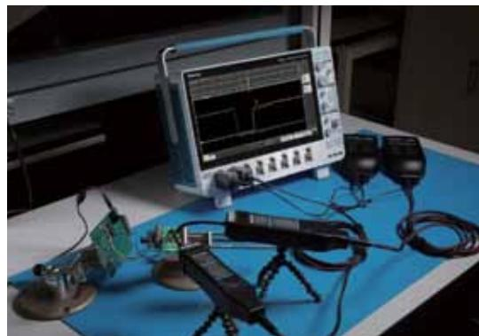
图 4. 许多电源拓扑要求在存在大的共模信号时测量小的差分电压。例如，半桥开关阶段高侧的 V<sub>GS</sub> 和 V<sub>DS</sub> 通常会相对于地电平上下移动几百或几千伏的电压。IsoVu™ 隔离测量系统可以与 5 系列 MSO 结合使用，提供超高共模抑制功能。
